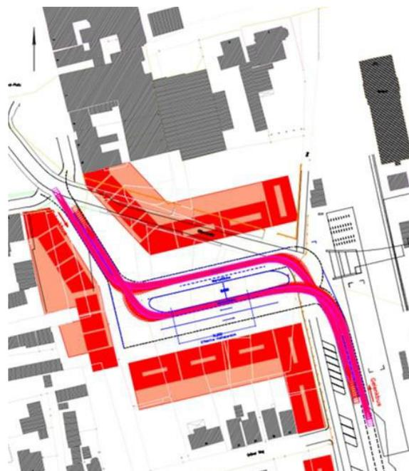
Abbildung 29 Analyse Kapazität der Bus-Insel nach Rahmenplan; alternativer Fahrweg (südliche Kante)
