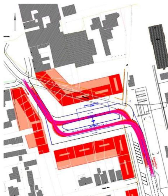
Abbildung 27 Analyse Kapazität der Bus-Insel nach Rahmenplan; alternativer Fahrweg (nördliche Kante)
